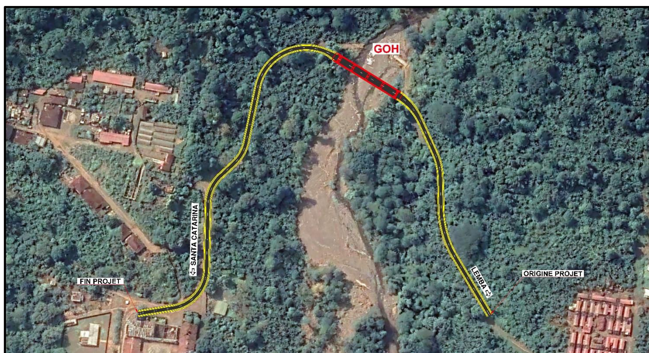
Figura 22 : Alinhamento das estradas de acesso à ponte de Brigoma
